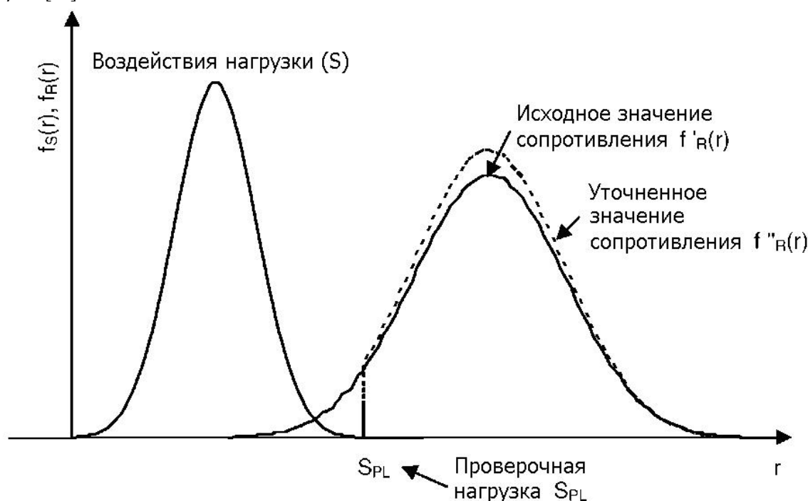
Рис. 9. Воздействие проверочной нагрузки на распределение прочности конструкции
