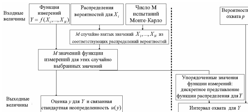
Рисунок 8 – Оценивание неопределенности измерения с использованием метода Монте-Карло, на котором левая от прерывистой линии часть рисунка относится к получению оценки y выходной величины Y и связанной стандартной неопределенности u(y) , а оставшаяся часть относится к определению интервала охвата для Y
